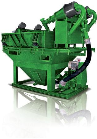
**APPLICATION** Le crible à sable GCS de COMEC est un système hautement efficace, compact et modulaire pour le criblage et l'extraction des boues du sable. L'admission tangentielle du mélange eaux bourbeuses - sables dans le cyclone provoque un effet centrifuge, qui permet de séparer le sable et l'eau.
